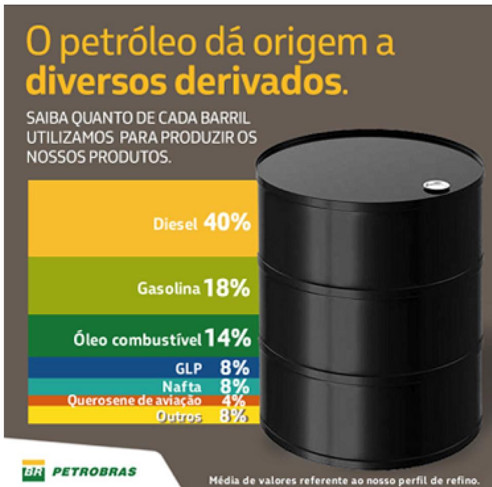
Por meio da atividade de refino, o óleo bruto é transformado em uma série de derivados essenciais para o dia a dia. Cada barril de petróleo, que tem o volume aproximado de 158,98 litros, dá origem a diferentes produtos, como gasolina, diesel, lubrificantes, nafta, querosene de aviação, entre outros.
